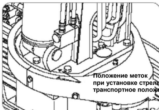
2. Опустите стрелу до предела. Обратите внимание, чтобы крюк не ударял по кабине водителя, когда он располагается впереди или по кузову крана-манипулятора, если располагается сзади.
