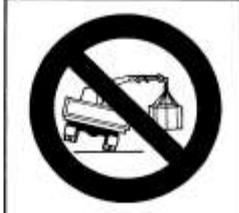
VIETATO USARE LA GRU SENZA GLI STABILIZZATORI IN POSIZIONE DI LAVORO (BRACCI COMPLETAMENTE APERTI E STABILIZZATORI A TERRA)
