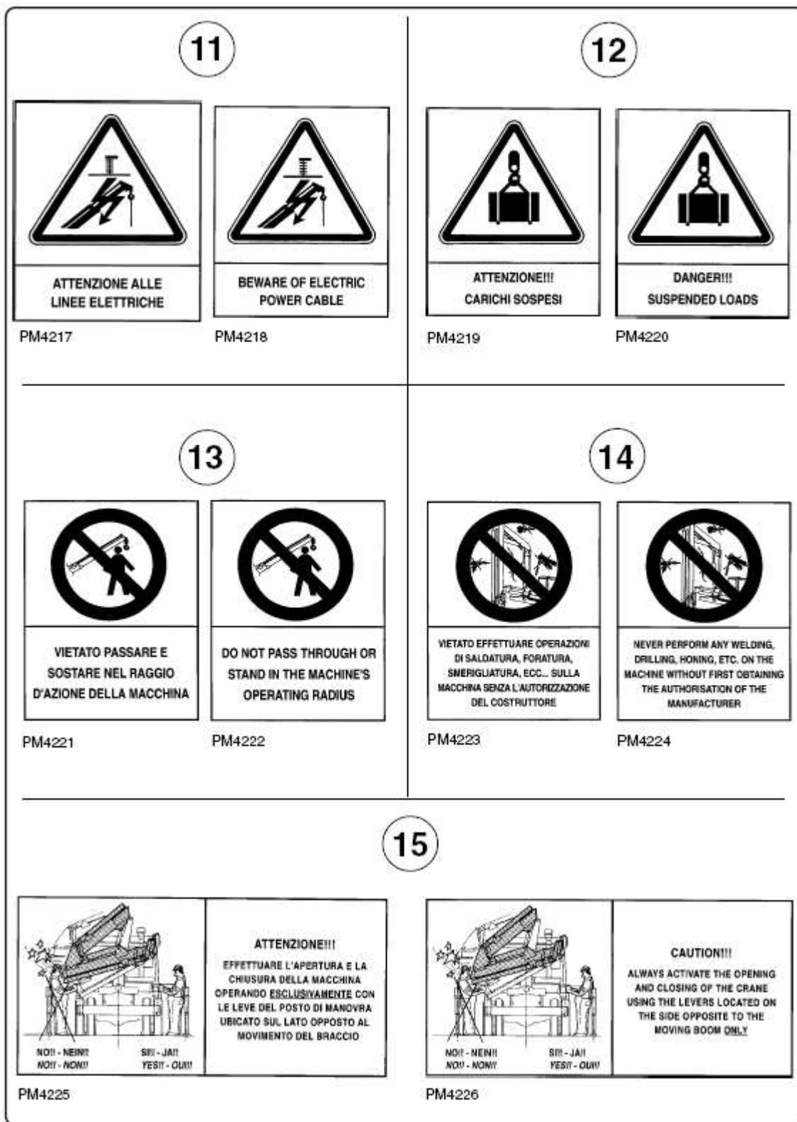
11. Наклейка на баке – Берегись контакта с проводами линий электропередач
