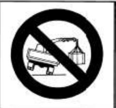
DO NOT USE THE CRANE WHEN ITS OUTRIGGERS ARE NOT IN OPERATING POSITION (BOOMS FULLY EXTENDED AND OUTRIGGERS RESTING ON THE GROUND)
