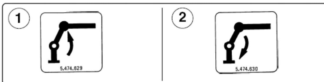
Около каждого рычага управления краном помещены две таблички, иллюстрирующие маневры, которые вы начнете с помощью этого конкретного рычага. Например, возле рычага управления цилиндром колонны вы найдете две таблички, помещенные одна над другой.
