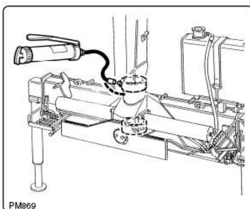
Втулки должны смазываться с помощью шприца. При смазывании поворачивайте колонной для равномерного распределения смазки.
