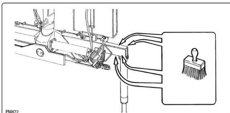
Ролики направляющих опор смазываются тоже с использованием шприцевания.
