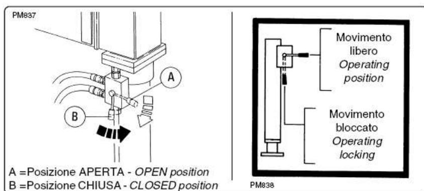
Для разблокировки движений каждого конкретного цилиндра опоры на нём установлен двухходовой кран-переключатель. Следуйте указаниям на наклейке для его открытия.
