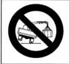
VIETATO USARE LA GRU SENZA GLI STABILIZZATORI IN POSIZIONE DI LAVORO (BRACCI COMPLETAMENTE APERTI E STABILIZZATORI A TERRA)
