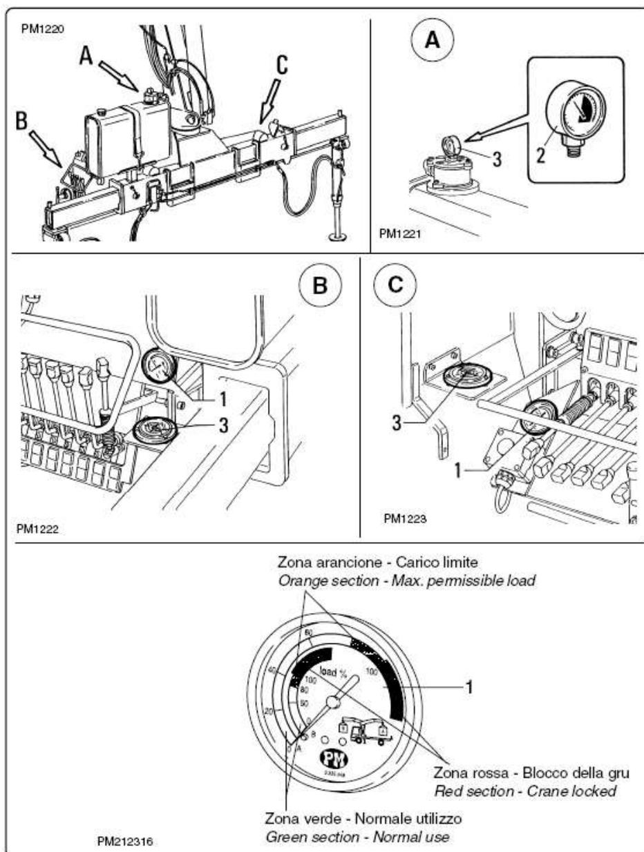
**A. Манометр низкого давления монтируется на фильтре, вставленном в бак.**
