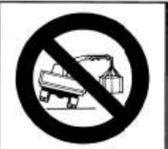
DO NOT USE THE CRANE WHEN ITS OUTRIGGERS ARE NOT IN OPERATING POSITION (BOOMS FULLY EXTENDED AND OUTRIGGERS RESTING ON THE GROUND)
