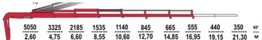
При этом масса крана, и размеры остаются прежними! 2460кг для данной версии 2.26, что же выросло? Давление! 33,5Мпа, при этом электроника снижает динамический эффект – значительным уменьшением скорости, но только на последнем этапе, когда кран уже дошел до 90% нагрузки. До этого момента, рабочая скорость максимальна!
