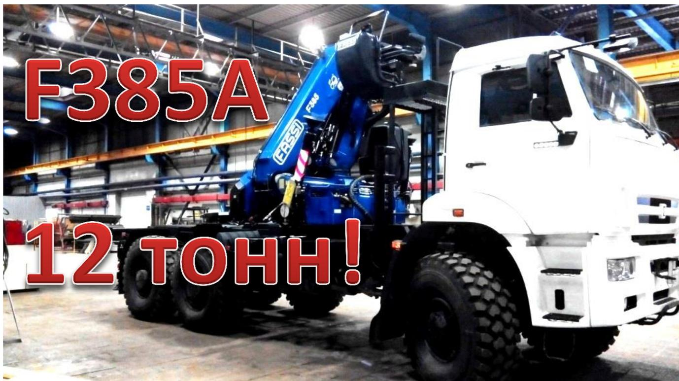
**Азнакаевский завод Нефтемаш**, старейший установщик КМУ в Татарстане, выпустил под новый год тягач КАМАЗ 6522 с краном FASSI F385 ( Италия) необычного синего цвета , Это пожалуй самый мощный манипулятор, который ставили на полноприводное шасси 6\*6
