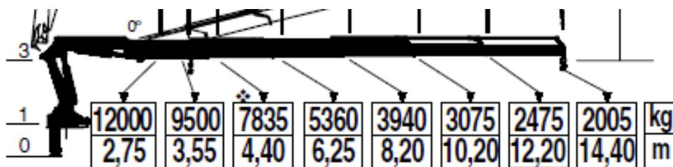
переворотные гидравликой опоры и пара задних опор – дополняют решение **Длинная складная стрела - оптимальный выбор для работы с полуприцепом.** 14 метровая стрела позволяет обслуживать всю длину
