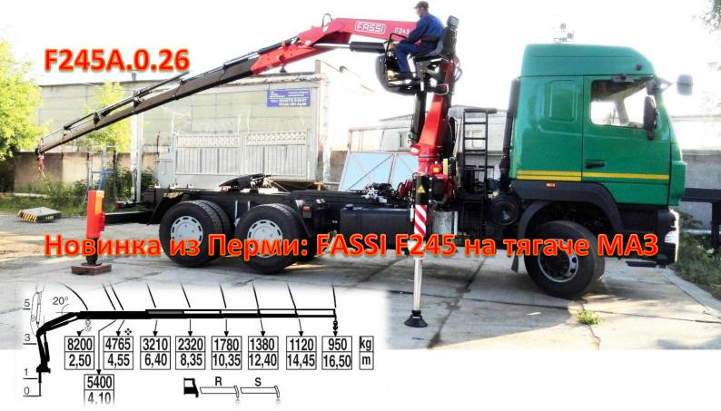
Для погрузки полуприцепа, а также для проведения монтажных работ Торговый Дом Грузовой Техники, Пермь изготовил, для своего заказчика из Тюмени кран манипулятор на тягаче MA3
