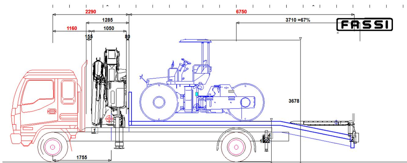
Машина для перевозки строительной техники и бытовок с манипулятором и аппаратами, отличается высоким уровнем многофункциональности, благодаря широкому ряду предлагаемых манипуляторов и вариантов исполнения платформы и аппаратов
