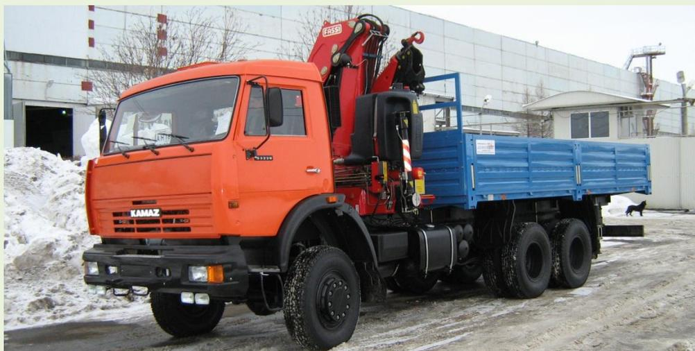
Автомобиль оснащён крано-манипуляторной установкой Fassi, предназначенной для самопогрузки и разгрузки бортовой платформы автомобиля, а также для выполнения монтажных работ на рассредоточенных объектах. Возможна установка других моделей манипуляторов Fassi на данное шасси, от серии «Микро» до F 330, за кабиной или на задний свес автомобиля.
