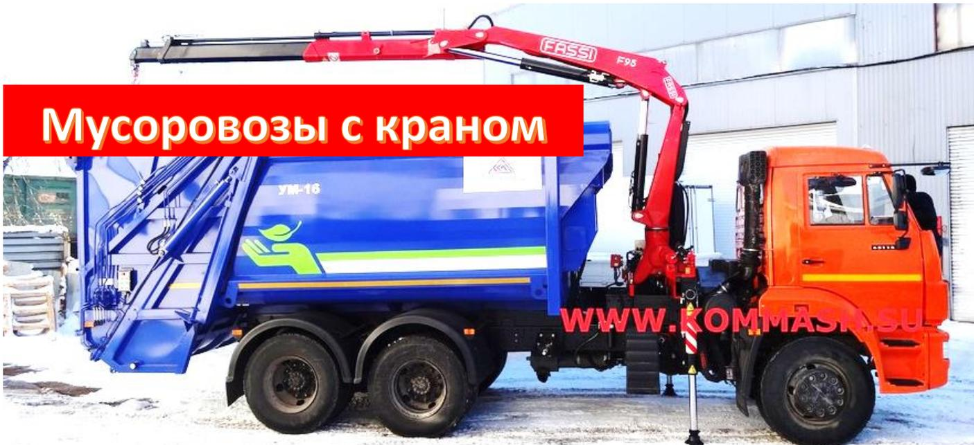
Мусоровоз с манипулятором FASSI, для работы с заглубленными контейнерами – известный продукт Торгового дома СПЕЦКОММАШ. Базовым шасси, в зависимости от потребностей заказчика, может быть как 2х осная 43253 так и 3х осная машина 65115. Радио управление крана, решает все проблемы с ограничением обзором, поскольку оператор может находиться, рядом с грузом и управлять стрелой, с пульта на поясе
