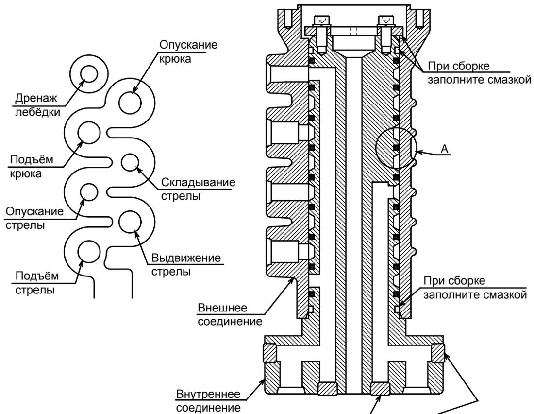
Перед затягиванием винта с шестигранным отверстием нанесите "Lock tight #202".
