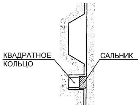
Установка уплотнительных колец
